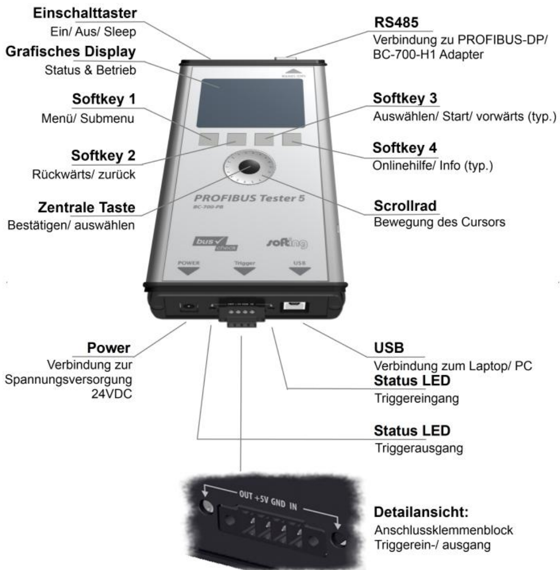
Abbildung 10: Anschlüsse, Bedienknöpfe und Statusanzeige des BC-700-PB
