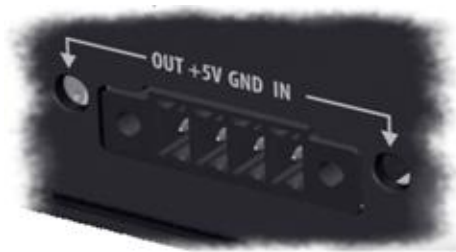
Abbildung 30: Anschlussklemmenblock des BC-700-PB
