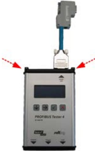
Abb. 12: Halteschlaufen zur Zugentlastung
